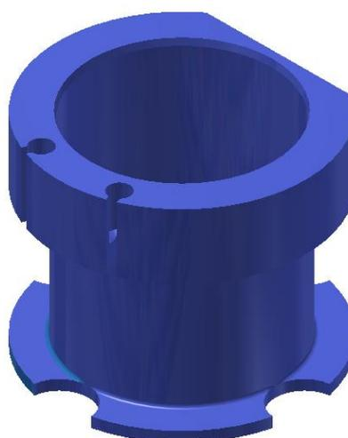
Рисунок 42 – Усовершенствование каркаса катушки
